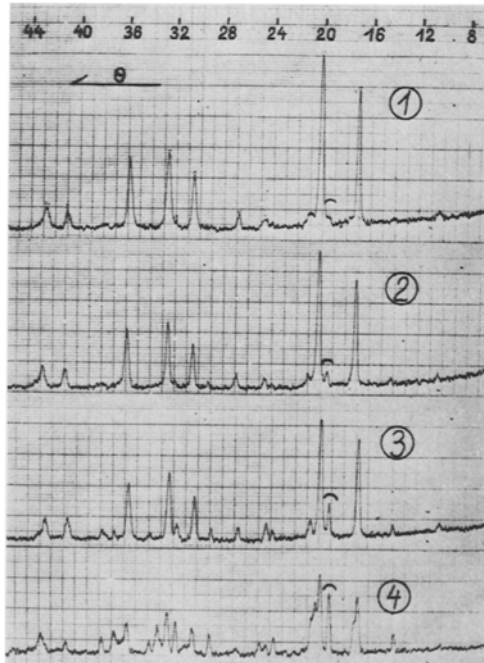
Abb. 1. Diffraktogramme des Kadmiumferrits; Auflösung in 10 m -HCOOH. 1. Vor der Auflösung; 2. Auflösung bei 20 °C; 3. Auflösung bei 40 °C; 4. Auflösung bei 60 °C
